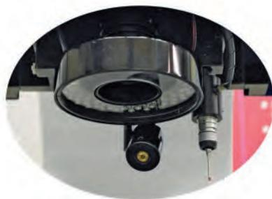
Gruppo ottico con puntatore laser e tastatore
